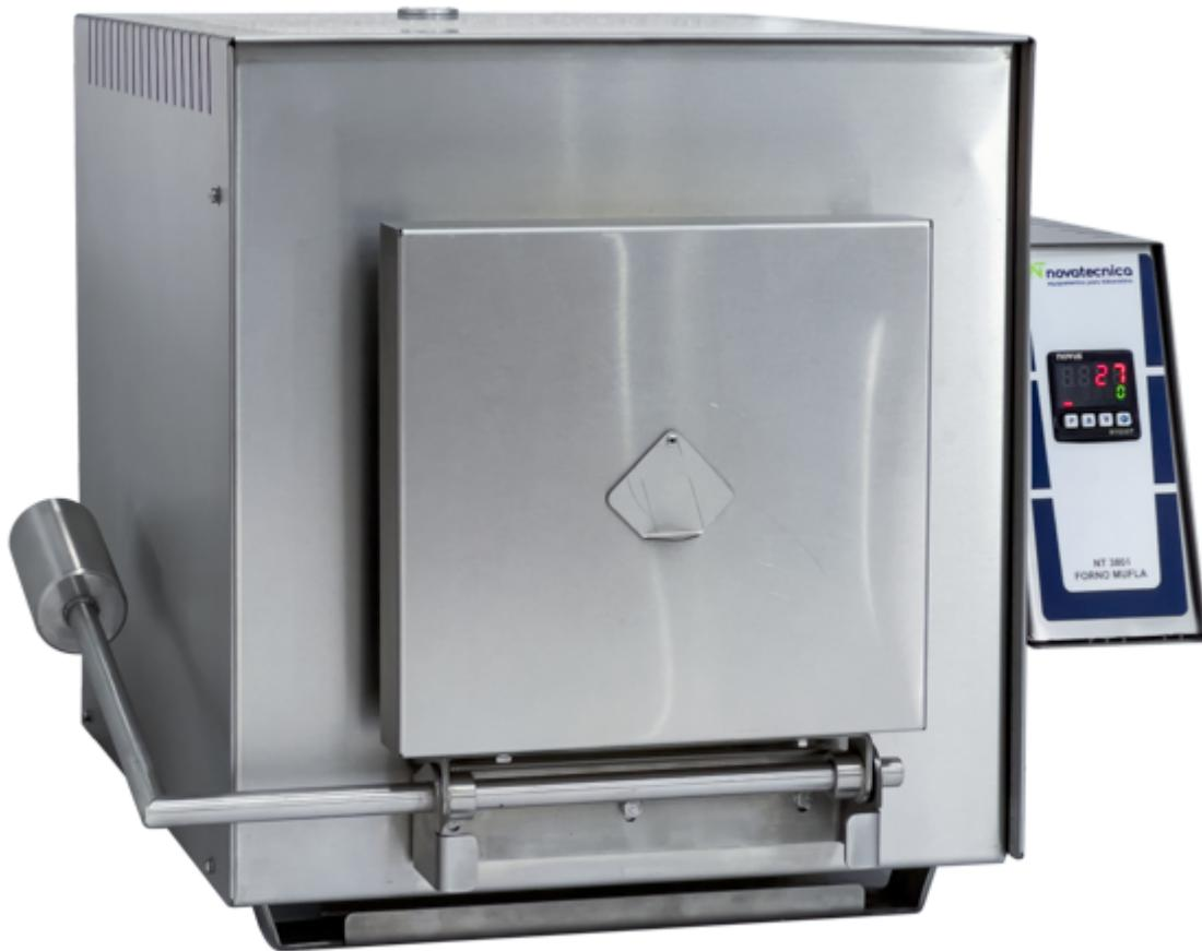
Forno mufla para laboratório, totalmente em inox, utilizado em processos que exijam temperaturas elevadas, como análises de calcinação, cinza total, alívio de tensão, cementação, têmpera, sinterização, secagem, queimas diversas, polimerização, queima de amostras e outras. Temperatura até 1.100°C e volume de 6,7 litros.
