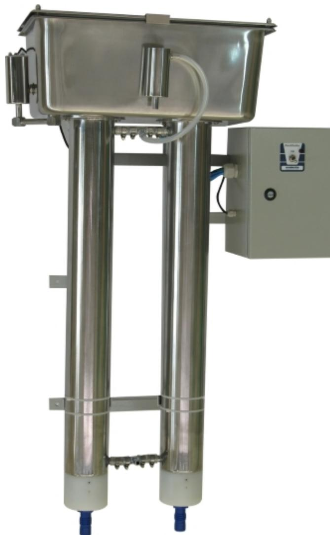
Destilador de água Tipo Pilsen para laboratório, construído inteiramente em aço inox AISI 304, utilizado no processo de purificação da água. Produz água com pureza abaixo de 4  $\mu$ S, considerando entrada até 300  $\mu$ S. Produção nominal de 20 litros/hora.
