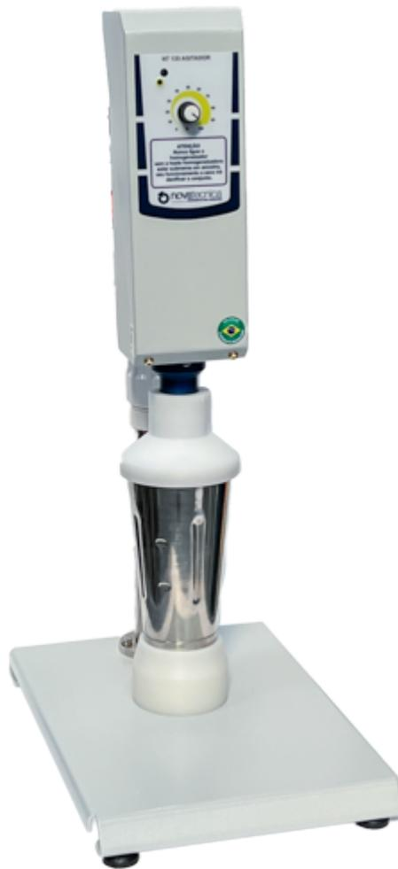
Agitador dispensor de solo utilizado em laboratórios de solos e geotecnia para realizar a dispersão de amostras de solo em suspensão líquida. Ideal para testes laboratoriais para análises geotécnicas, como determinação da granulometria do solo, limites de Atterberg, compactação, entre outros. Velocidade até 25.000 Rpm e copo com volume de 700 ml, em aço inox AISI 304.
